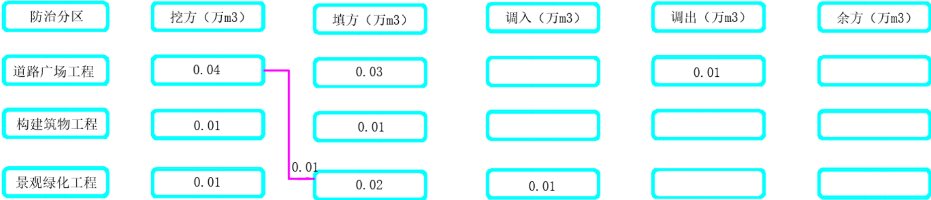
图 2-3 土石方流向图框
